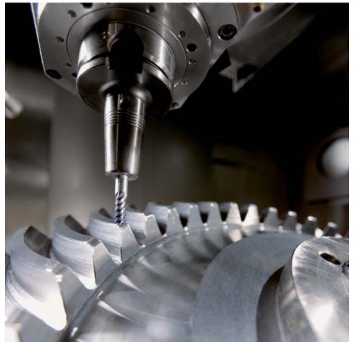
Alle Einflüsse zusammen sind mitverantwortlich für Maßabweichungen und Fehler auf der Oberfläche von Werkstücken. Sie haben somit entscheidenden Einfluss auf die Qualität und im Fall von qualitätsbedingten Ausschussteilen auch auf die Produktivität. Dynamic Precision wirkt ihnen mit intelligenter Regelungstechnologie entgegen und hilft die Qualität und Dynamik einer Werkzeugmaschine weiter zu verbessern. Das spart Zeit und Kosten in der Fertigung.
